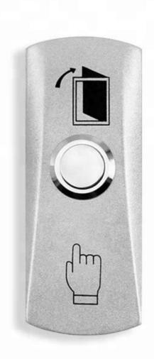
Artículo: botón de salida Modelo: DH-K802A Material: aleación de zinc Tamaño: 83L \* 32W \* 25H (mm) Grado actual: 3A @ 36VDC Max Elevación mecánica: 50,000 veces Contacto de salida: NC / COM
